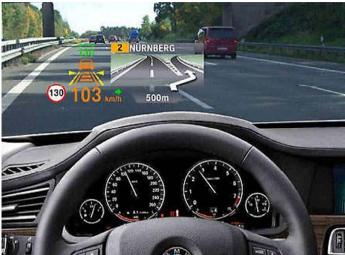
Obr.5. Příklad zobrazení informací na HUD (Blažek, 2011)
