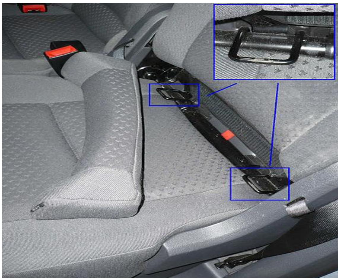
Obr.6. Systém Isofix – sedadlo vozidla, kde je možný úchyt sedačky. (wikipedia)
