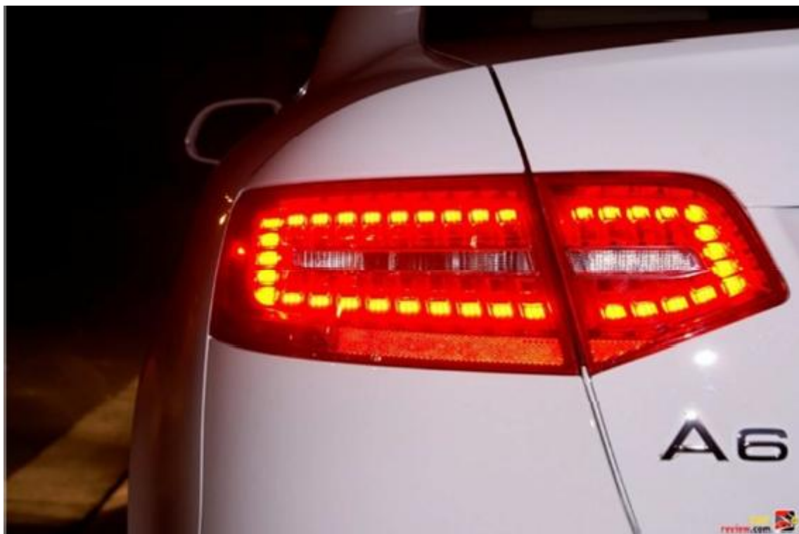
Obr.3. Zadní světla s LED diodami (Blažek, 2011)
