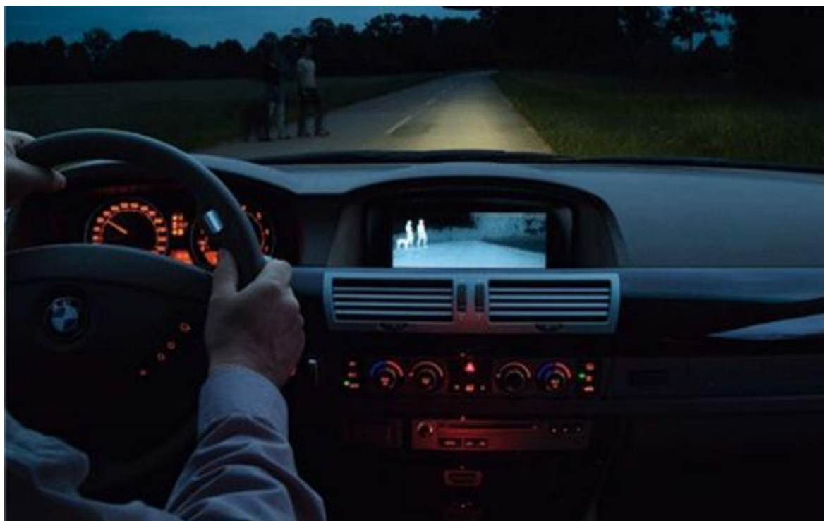
Obr.4. Systém pro noční vidění automobilky BMW (Blažek, 2011)
