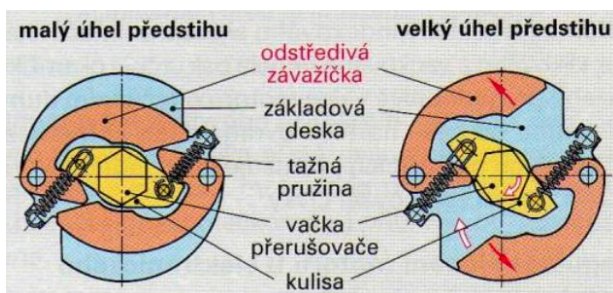
Odstředivý regulátor předstihu v rozdělovači
