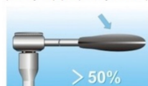
Obr. 39 Zásady pro správnou montáž a demontáž zapalovacích svíček s použitím momentového klíče.[11]
