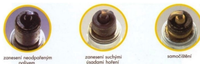
Obr. 26 Různá úroveň samočištění zapalovacích svíček. [11]
