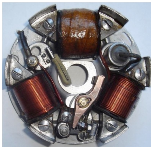
Obr. 12 Stator setrvačnickového magneta.[8]
