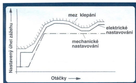
Obr. 20 Srovnání mechanické a elektronické regulace předstihu.[2]
