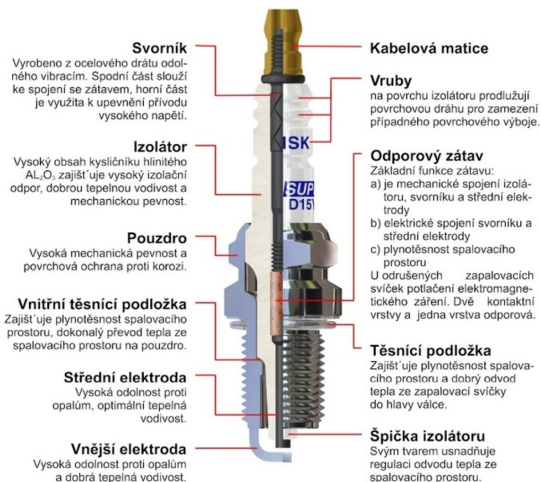
Obr. 27 Řez zapalovací svíčkou Brisk Super [11]
